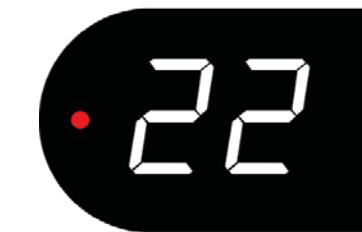
Temperatura okoline se prikazuje na ekranu. Ukoliko temperatura ne odgovara temperaturi izmerenoj termometrom, tada je potrebno izvršiti kalibraciju. Na primer, radijator prikazuje da je temperatura u prostoru 20°C; međutim drugi termometar pokazuje da je temperatura 22°C. Tada možete da izvršite kalibraciju i podesite temperaturu koju ste izmerili na referentnom termometru.
